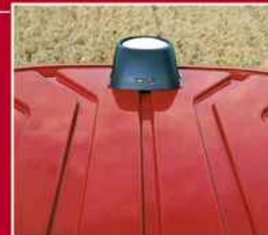
AFS sistemi barındırdığı hassas ölçüm sistemleri özellikle bicerdöver mütəahhitleri için oldukça faydalıdır. Sistem uydu ile gerçekleştirdiği sinyal alışverişini kabin tavanındaki anten aracılığı ile sağlar.
