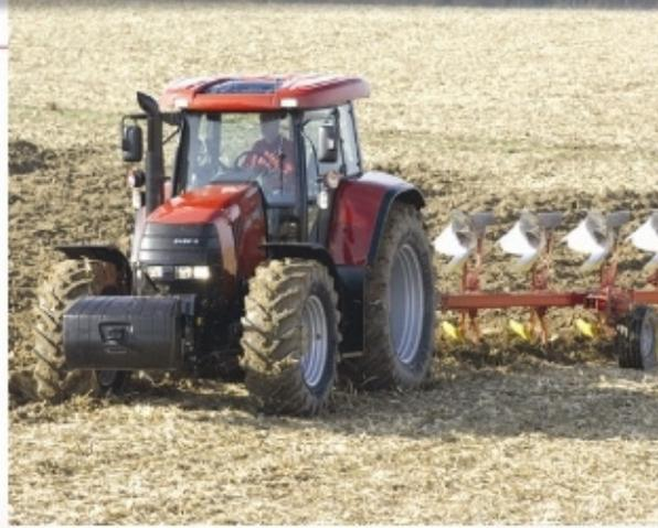
Ön aks süspansiyon sistemi CVX Serisi'nde opsiyonel olarak bulunmaktadır. Çeki performansını arttıran bu sistem aynı zamanda engebelerin kabin içinde yaratacağı düzensizlikleri ortadan kaldırır.
