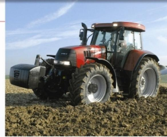
CASE IH CVX Serisi standardı olan **Sürekli Değişken Transmisyon Sistemi**, en düşük hızlardan en yüksek hızlara kadar traktörün kullanıldığı her yerde operatöre büyük kolaylık sağlar. Vites değiştirme sorununu ortadan kaldıran bu sistem, motorun devir hızını ölçer ve buna göre gerekli olan hızı kendisi belirler. Saatte bir metre gitmek mi istiyorsunuz? Birakın bunu sizin için CVX yapsın.
