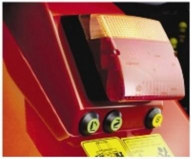
Her iki arka çamurlukta da bulunan hidrolik kol kumandası, kuyruk mili kumandası ve hidrolik çıkışları yönlendiren kumanda butonları standart olarak bulunmaktadır. Böylelikle kabin içine girmeden kolayca ekipman bağlantısı yapılabilir.
