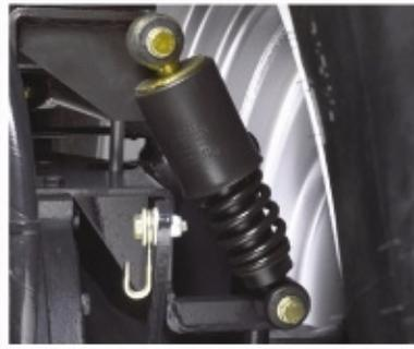
**Mekanik kabin süspansiyonu** CVX Serisi'nde standarttır ve titreşimleri en alt seviyede tutarak sürücüye rahat çalışma ortamı sunar.
