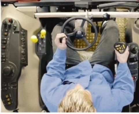
CVX Serisi'nde CVX 175 ve CVX 195 modellerinde seçenek olarak sunulan **Geri Sürüş Sistemi** sayesinde, silaj makinesi, beko loder, toprak burgusu ve sap kıyıcı gibi ekipmanların kullanımı oldukça kolaylaşmaktadır. Bunun için tek yapmanız gereken koltuğunuzu geri çevirerek, traktörde bulunan 2. direksiyonla geri sürüşü rahat bir şekilde yapmak.
