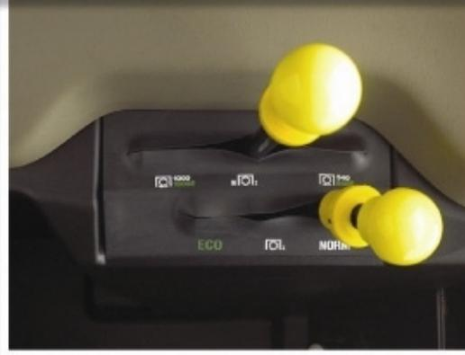
CVX Serisi'nde standart olan bir özellikte **4 hızlı kuyruk milidir**. Bütün kuyruk mili tahrikli ekipmanların kolaylıkla kullanılabilmesini sağlayan bu sistem sayesinde daha düşük motor devirlerinde istenilen kuyruk mili devri rahatlıkla elde edilir.
