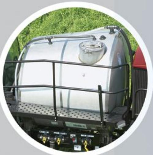
**Case IH SPX 3320** kendi yürürlü ilaçlama makinasında kullanılan paslanmaz çelik malzemeden üretilmiş konik sıvı deposu **3.785 l**'lik geniş hacmi ile uzun saatler boyu kesintisiz çalışmayı garanti eder. Sıvı deposunun benzersiz şekli, ilaçlama makinasının arka tarafının ve ilaçlama kırısının kolaylıkla izlenebilmesini sağlar.
