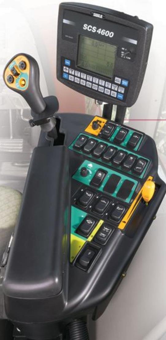
**Case IH SPX 3320** kendi yürürl ilaçlama makinasının tüm fonksiyonlarını kontrol eden kumanda düğmeleri, operatör koltuğuna bağlı olan kumanda konsolu üzerinde toplanmıştır ve koltukla birlikte hareket eder. Makinanın ileri-geri hareketini sağlayan ve aynı zamanda üzerinde ilaçlama kırışına kumanda eden düğmeleri barındıran çok fonksiyonlu kumanda kolu, adeta operatörün kolunun uzantısı gibidir.
