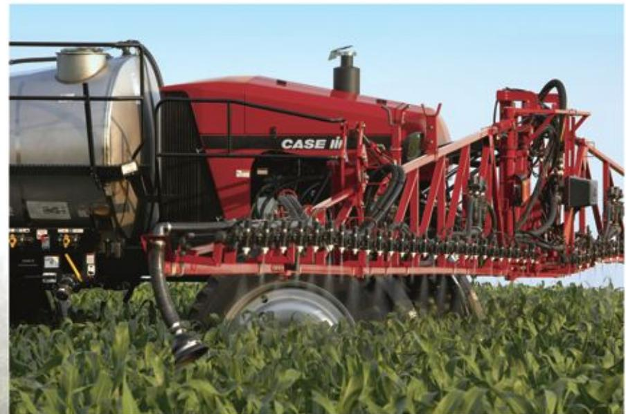
**Case IH SPX 3320** kendi yürürl ilaçlama makinasının sahip olduğu **30,5 m** genişliğindeki ilaçlama kirişi, yüksek kapasitede ilaçlama yapmayı garanti eder.
