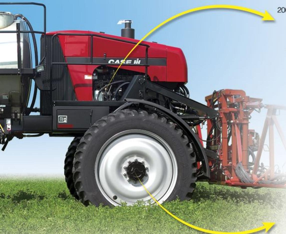
Case IH SPX 3320 kendi yürürlaçlama makinasında, Common-Rail yakıt enjeksiyon sistemine sahip **6,7 l hacimde Turbo-Diesel Case IH** marka motor kullanılmaktadır. **Tier III** standardındaki motor, 2000 d/d'da **235 HP güç**, 1400 d/d'da **1020 Nm tork** üretmektedir. Güçlü, güvenilir, çevre dostu ve ekonomik Case IH motor ile her türlü tarla koşulunda yüksek kapasitede çalışmak mümkündür.
