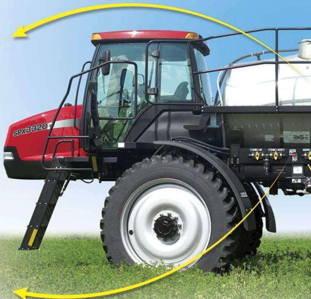
Case IH SPX 3320 kendi yürürlaçlama makinasının sahip olduğu **kabin-depo-motor-ilaçlama kırışı** şeklindeki ana yapısının beraberinde getirdiği ideal ağırlık dağılımı, her türlü tarla koşulunda yüksek kapasitede, güvenle çalışmayı sağlar. Öte yandan kabin, motor gürültüsünden, titreşimden ve ısından etkilenmez.
