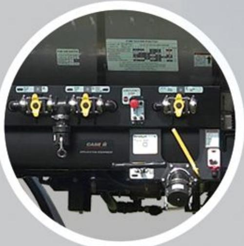
**Case IH SPX 3320** kendi yürürlü ilaçlama makinasının ilaçlama sistemine ait tüm valfler ve vanalar, tek bir **servis merkezi** üzerinde toplanmıştır. Doldurma, ilaçlama, devirdaim ve benzeri tüm fonksiyonları gerçekleştirmek için gerekli olan tüm valf ve vana düzenlemeleri, bu servis merkezinden kolaylıkla gerçekleştirilir.
