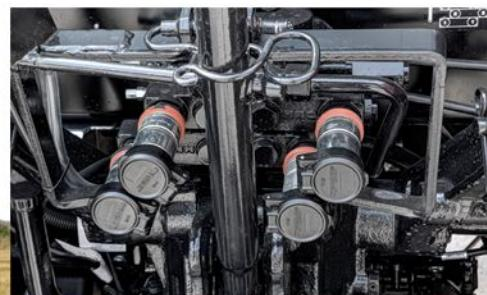
**Güçlü ve dayanıklı hidrolik sistem,** sahip olduğu 2.150 kg kaldırma kapasitesi, 4 adet hidrolik güç çıkışlı, kaydırımlı tip çeki sehpası ile pek çok ekipmanla etkin bir şekilde çalışabilmenizi sağlamaktadır.
