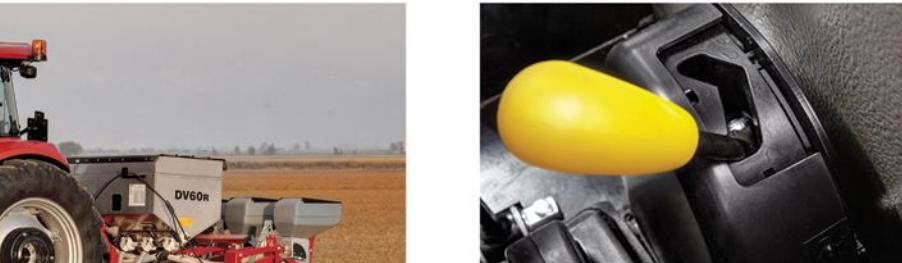
Yumuşak bir kuyruk mili kavramasını sağlayan servo kuyruk mili uygulaması, aynı zamanda traktörün durdurulması sonrasında otomatik olarak devre dışı kalarak güvenli bir kullanımı da sizlere sunmaktadır. Servo kuyruk mili uygulaması tüm powershuttle modellerde standart olarak sunulmaktadır.
