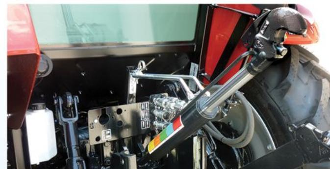
Orta hidrolik kol uygulaması ile kullanıcı kabin içinden orta hidrolik kolu kontrol ederek ekipman bağlamadan hidrolik derinlik ayarına kadar pek çok işlemi etkin bir şekilde gerçekleştirebilmektedir. Harici 2 adet hidrolik güç çıkışısı ile kontrol edilen, kullanıcılarla pratiklik ve kolay kullanım kazandıran orta hidrolik kol, tüm Case IH JX90/100 ve 110 modellerde standart olarak sunulmaktadır.
