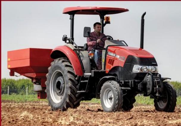
Case IH JX serisi tüm modellerde 540 d/d ve 540E d/d (750 d/d) kuyruk mili seçenekleri standart olarak sunulmaktadır. Sadece 1535 d/d gibi düşük bir devirde devreye giren 540E devir seçeneği sayesinde ekonomik bir kullanımı Case IH JX serisi sizin için garanti altına alacaktır.
